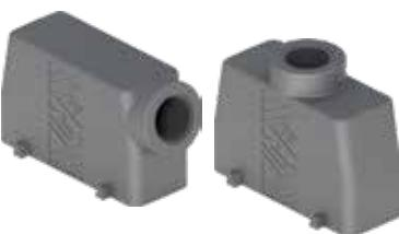
サーフェスマウントハウジングには片側にケーブルエントリーを装備しております。反対側のケーブルエントリーは閉じられていますが、ユーザーが必要に応じて（適切な工具を用いて）穴を開けることで、ダブルエントリーとしても使用できるようになっています。
