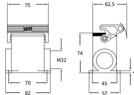
バルクヘッドハウジング用パネルカットアウト寸法 CHIN LCH および CHIN L
