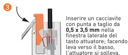
Inserire un cacciavite con punta a taglio da  $0,5 \times 3,5 \text{ mm}$  nella finestra laterale del tasto attuatore; facendo leva verso il basso, l'attuatore si solleva.
