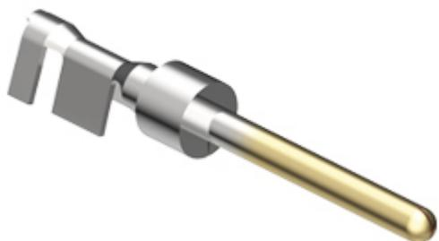
オス 圧着コンタクト, SI シリーズ, 5 A, プレス加工 金メッキ, 導体断面積 0,21 - 0,52 mm<sup>2</sup>, AWG 24 - 20, コイルパッケージ, 250 嵌合サイクル用
