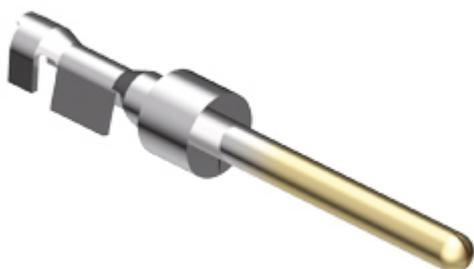
オス 圧着コンタクト, SI シリーズ, 5 A, プレス加工 金メッキ, 導体断面積 0,08 - 0,21 mm<sup>2</sup>, AWG 28 - 24, バラピン, 500嵌合サイクル用
