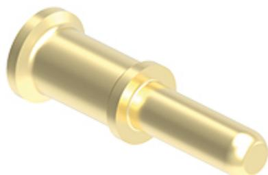
オス 圧着コンタクト, RX7 シリーズ, 70 A, 切削金メッキ, 導体断面積 16 mm<sup>2</sup>, AWG 6 - 5, Class6 高可とうケーブル用, HNM - 高嵌合回数バージョン
