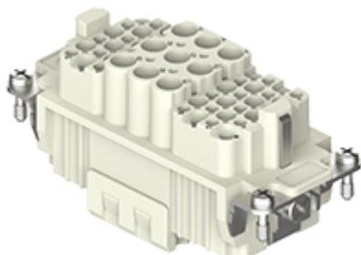
メス インサート, CX シリーズ, 圧着式結線, 9 + 42 極 + PE, 40 A 690 V 8 kV 3 / 10 A 250 V 4 kV 3, サイズ "77.27"
