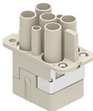
メス インサート, CQ シリーズ, 圧着式結線, 4 + 2 極 + PE, 40 A 400/690 V 6 kV 3 / 10 A 250 V 4 kV 3, サイズ "32.13", PEプレート付
