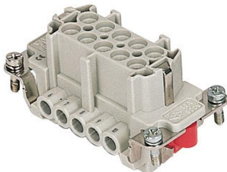
メス インサート, CME シリーズ, ネジ式結線, 3, 16 A 830 V 8 kV 3 / 16 A 500 V 6 kV 3, サイズ "57.27", プレート無し
