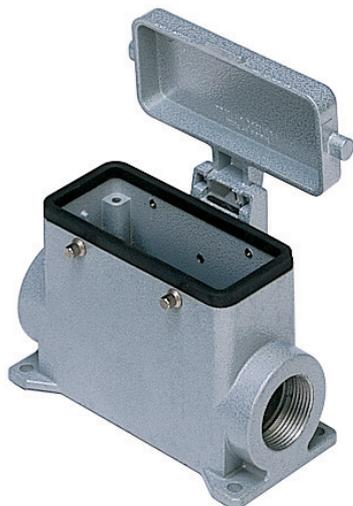
サーフェスマウントハウジング, C-タイプシリーズ, 4ペグ付, Pg29 ケーブルエントリー, サイズ "77.27", ハイコンストラクション, 金属カバー付
