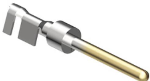
Contatto a crimpare maschio, serie SI, 5 A, stampato dorato, sezione conduttore 0,21 - 0,52 mm<sup>2</sup>, AWG 24 - 20, imballo in bandoliera, per 50 cicli di accoppiamento
