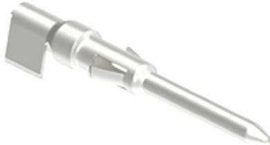
Contatto a crimpare maschio, serie SD, 10 A, stampato argentato, sezione conduttore 1,5 - 2,5 mm<sup>2</sup>, AWG 16 - 14, imballo in bandoliera, per 500 cicli di accoppiamento
