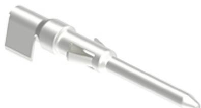
Contatto a crimpare maschio, serie SD, 10 A, stampato argentato, sezione conduttore 1,5 - 2,5 mm<sup>2</sup>, AWG 16 - 14, pezzi sciolti, per 500 cicli di accoppiamento
