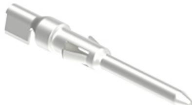
Contatto a crimpare maschio, serie SD, 10 A, stampato argentato, sezione conduttore 0,37 - 1 mm<sup>2</sup>, AWG 24 - 18, pezzi sciolti, per 500 cicli di accoppiamento
