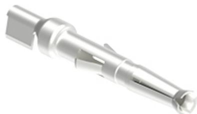
Contatto a crimpare femmina, serie SD, 10 A, stampato argentato, sezione conduttore 0,37 - 1 mm<sup>2</sup>, AWG 24 - 18, pezzi sciolti, per 500 cicli di accoppiamento
