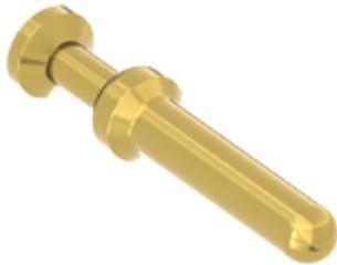
Contatto a crimpare maschio, serie RX, 40 A, tornito dorato, sezione conduttore 6 mm<sup>2</sup>, AWG 10, versione HNM - High Number of Matings
