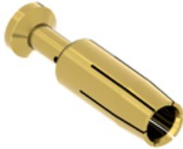
Contatto a crimpare femmina, serie RX, 40 A, tornito dorato, sezione conduttore 1,5 mm<sup>2</sup>, AWG 16, versione HNM - High Number of Matings
