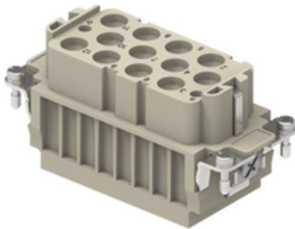
Frutto presa, serie RX, connessione a crimpare, 12 + 2 poli + PE, 40 A 690 V 8 kV 3 / 10 A 250 V 4 kV 3, grandezza "77.27", versione HNM - High Number of Matings
