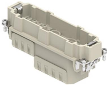
Frutto spina, serie RXC, connessione a crimpare, 4 + 8 poli + PE, 80 A 400 V 6 kV 3 / 16 A 230/400 V 4 kV 3, grandezza "104.27", versione HNM - High Number of Matings
