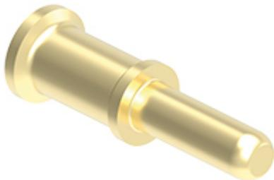
Contatto a crimpare maschio, serie RX7, 70 A, tornito dorato, sezione conduttore 16 mm<sup>2</sup>, AWG 6 - 5, conduttore classe 6 extra-flessibile, versione HNM - High Number of Matings
