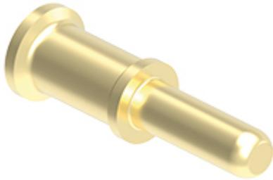
Contatto a crimpare maschio, serie RX7, 70 A, tornito dorato, sezione conduttore 10 mm<sup>2</sup>, AWG 8 - 7, versione HNM - High Number of Matings
