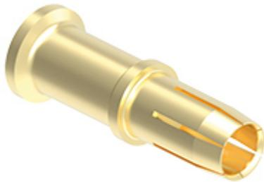
Contatto a crimpare femmina, serie RX7, 70 A, tornito dorato, sezione conduttore 10 mm<sup>2</sup>, AWG 8 - 7, versione HNM - High Number of Matings
