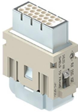
Frutto presa modulare, serie Mixo, connessione a crimpare, 20 poli, 1 modulo, 4 A 32 V 0,8 kV 3, schermato, con connessione di terra aggiuntiva, versione HNM
