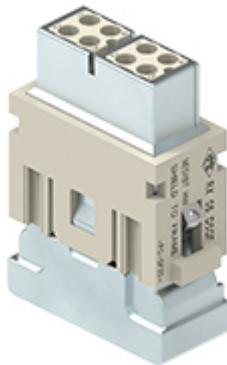
Frutto presa modulare, serie Mixo Megabit, connessione a crimpare, 8 poli, 1 modulo, 10 A 50 V 0,8 kV 3, schermato, con connessione di terra aggiuntiva, versione HNM, 1 ingresso cavo
