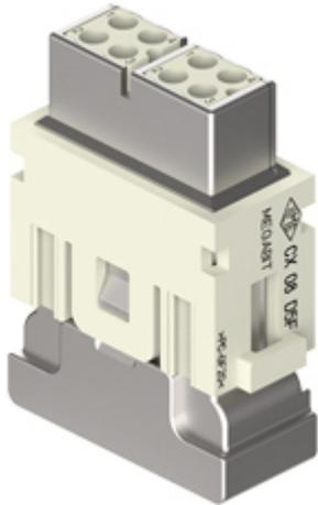
Frutto presa modulare, serie Mixo Megabit, connessione a crimpare, 8 poli, 1 modulo, 10 A 50 V 0,8 kV 3, schermato, 1 ingresso cavo, versione HNM - High Number of Matings
