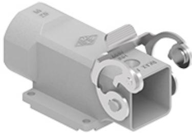
Custodia da incasso ad angolo, serie CKA, serie HNM - High Number of Matings, con 1 leva, con 1 leva, ingresso cavo M25 con uscita pressacavo, grandezza "21.21", con foro incasso chiuso
