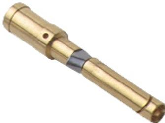
Contatto a crimpare femmina, serie RD, 10 A, tornito dorato, sezione conduttore 0,14 - 0,37 mm<sup>2</sup>, AWG 26 - 22, versione HNM - High Number of Matings
