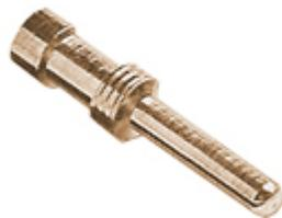
Contatto a crimpare maschio, serie RC, 16 A, dorato, sezione conduttore 0,5 mm<sup>2</sup>, AWG 20, apertura anticipata, versione HNM - High Number of Matings
