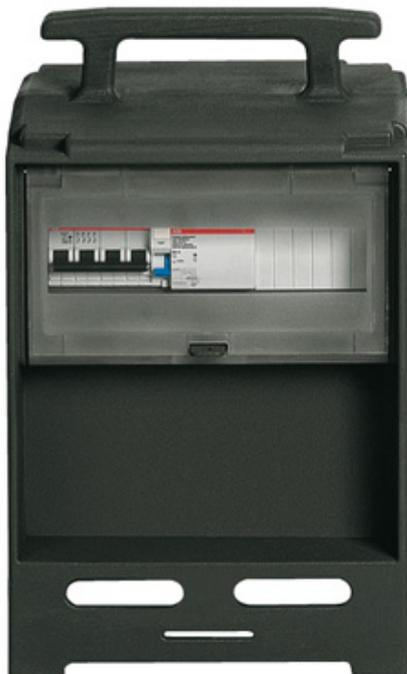
Quadro da cantiere assemblato (ASC), serie Q, con 4 prese PLUSO PEW...PQ/PQF, interruttore magnetotermico 16 A, potenza massima 9 kW
