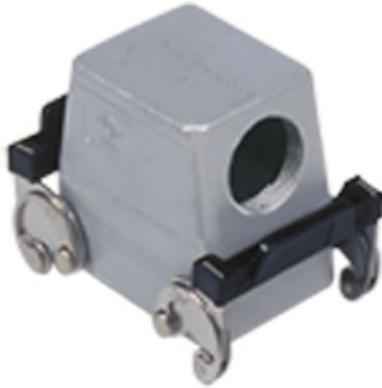
Custodia mobile, serie C-TYPE, con 2 leve, ingresso cavo orizzontale M32 senza adattatore, grandezza "66.40", alta, senza guarnizione
