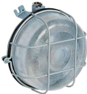
Apparecchio di illuminazione fisso per usi generali, forma tonda, IP65, portalampada E27, 1 x MAX 60 W, ingresso cavi G 1/2 con pressacavo
