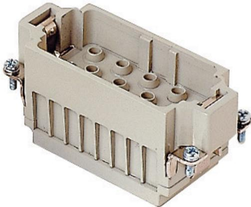
Frutto spina, serie CX, connessione a crimpare, 12 + 2 poli + PE, 40 A 690 V 8 kV 3 / 10 A 250 V 4 kV 3, grandezza "77.27"
