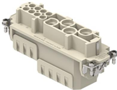
Frutto presa, serie CXC, connessione a crimpare, 4 + 8 poli + PE, 80 A 400 V 6 kV 3 / 16 A 230/400 V 4 kV 3, grandezza "104.27"
