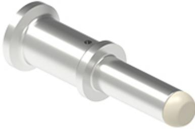
Contatto a crimpare maschio, serie CX7, 70 A, tornito argentato, sezione conduttore 16 mm<sup>2</sup>, AWG 6 - 5, conduttore classe 6 extra-flessibile, versione finger-proof
