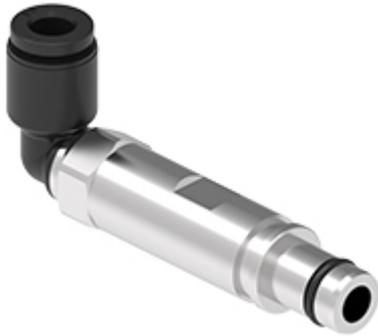
Contatto pneumatico metallico maschio, angolare orientabile 90°, con innesto rapido, senza valvola di chiusura, diametro esterno 6 mm
