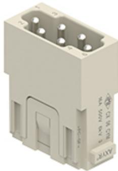
Frutto spina modulare, serie Mixo, connessione rapida AXYR® push-in con morsetto a molla, 6 poli, 1 modulo, 16 A 500 V 6 kV 3
