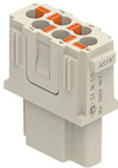
Frutto presa modulare, serie Mixo, connessione rapida AXYR® push-in con morsetto a molla, 6 poli, 1 modulo, 16 A 500 V 6 kV 3
