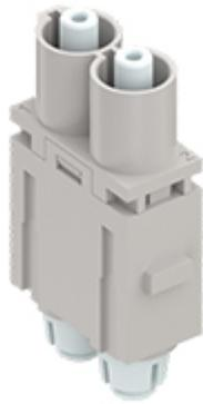
Frutto presa modulare, serie Mixo, connessione a crimpare, 2 poli, 1 modulo, 16 A 2500 V 15 kV 3, con tubo termorestringente
