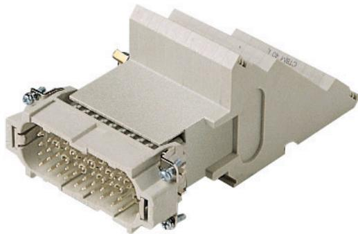
Frutto spina, serie CTS, connessione con morsetto a molla, 40 poli + PE, 10 A 250 V 4 kV 3, grandezza "77.27", con morsettiera incorporata, montaggio lato destro
