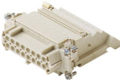
Frutto presa, serie CT, connessione con morsetto a vite, 16 poli + PE, 16 A 230/400 V 4 kV 2, grandezza "77.27", con morsettiera incorporata, montaggio lato destro
