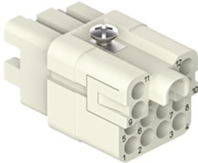
Frutto presa, serie CQ, connessione a crimpare, 12 poli + PE, 7,5 A 250 V 4 kV 3, grandezza "21.21", per adattatore PCB CIF Q12 2.4, pin contatto PE diametro 1 mm
