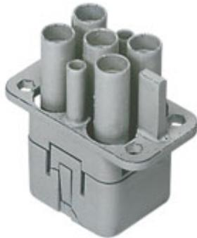
Frutto presa, serie CQ, connessione a crimpare, 4 + 2 poli + PE, 40 A 400/690 V 6 kV 3 / 10 A 250 V 4 kV 3, grandezza "32.13"
