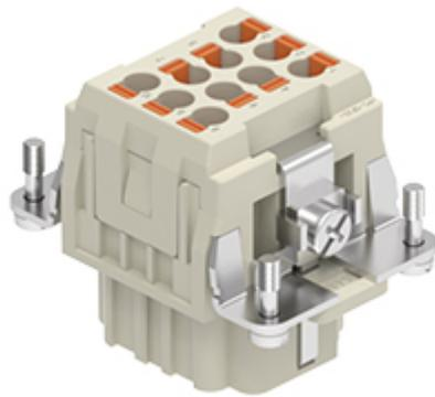
Frutto presa, serie CQEY, connessione rapida AXYR® push-in con morsetto a molla, 10 poli + PE, 16 A 500 V 6 kV 3, grandezza "44.27"
