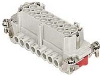
Frutto presa, serie CME, connessione con morsetto a vite, 6 + 2 poli + PE (17-32), 16 A 830 V 8 kV 3 / 16 A 500 V 6 kV 3, grandezza "77.62", senza piastrina
