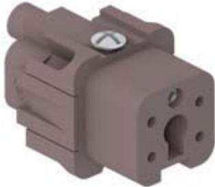
Frutto presa, serie CK RY, connessione con morsetto a vite, 4 poli + PE, 10 A 230/400 V 4 kV 3, grandezza "21.21", per applicazioni fino a 180°C
