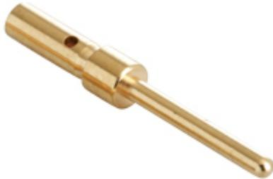
Contatto a crimpare maschio, serie CI, 5 A, dorato, sezione conduttore 0,13 - 0,33 mm<sup>2</sup>, AWG 26 - 22, doratura base
