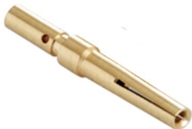
Contatto a crimpare femmina, serie CI, 5 A, dorato, sezione conduttore 0,52 - 0,75 mm<sup>2</sup>, AWG 20 - 18, doratura base
