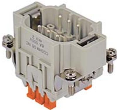
Frutto spina, serie CDSH NC, connessione rapida con morsetto a molla SQUICH®, 6 poli + PE, 6 A 250 V 6 kV 3, grandezza "44.27", con elemento di contatto AutoShort NC
