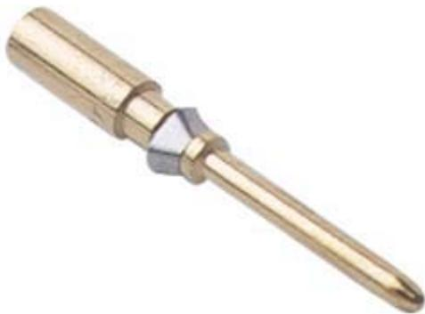
Contatto a crimpare maschio, serie CD, 10 A, tornito dorato, sezione conduttore 0,14 - 0,37 mm<sup>2</sup>, AWG 26 - 22, doratura ad alto spessore
