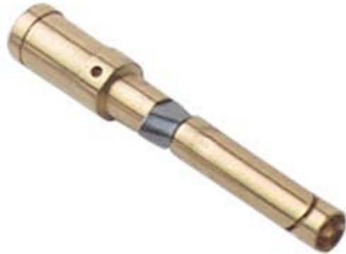
Contatto a crimpare femmina, serie CD, 10 A, tornito dorato, sezione conduttore 2,5 mm<sup>2</sup>, AWG 14, doratura ad alto spessore
